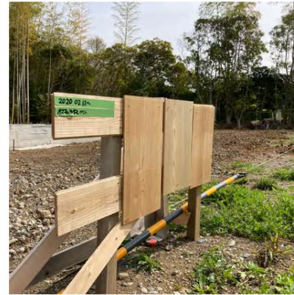
外壁塗料の暴露試験
